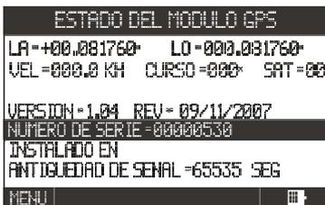
3.4.3 INSTALADO EN: se lo utiliza, en caso de querer personalizar la instalación. Colocar el nombre del cliente o de la empresa, en el cual fue instalado (8 caracteres alfanuméricos).
