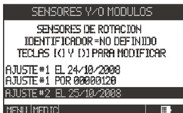
3.5.2.2 AJUSTAR RPM: ingresar, colocar la cantidad de dientes del engranaje (pulsos por vuelta) y presionar enter.
